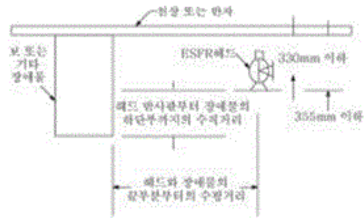
그림 2.7.1.8(1) 보 또는 기타 장애물 위에 헤드가 설치된 경우의 반사판 위치 (그림 2.7.1.8(3) 또는 표 2.7.1.8(1)을 함께 사용할 것)
